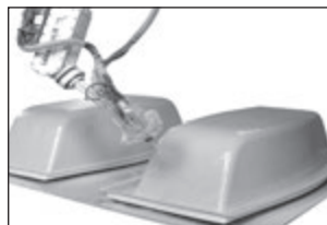
Vyztužení výlisku Zpevnění výlisku pryskyřicí s přídavkem skelného vlákna.
