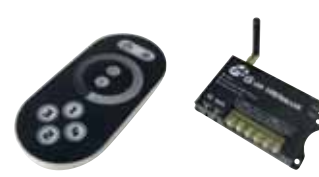
N2098 LED ovladač RF24 umožňuje nezávislé ovládání až 4 okruhů pomocí 1-4 přijímačů. Na jednom okruhu můžete mít několik přijímačů a okruh ovládat najednou. Ovládat lze každý okruh 1-4 samostatně, nebo po aktivaci společného tlačítka všechny 4 okruhy najednou. LED ovladač RF24 obsahuje 1 dálkový ovladač. K tomuto ovladači se dokupují samostatně další přijímače N2099, které můžete naladit do stejného okruhu nebo vytvořit další okruh.
