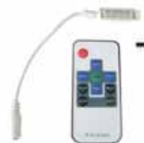
N2413 MINI ovladač pro RGB pásy umožňuje ovládat intenzitu, nastavení barev a barevných přechodů. Ovladač je rádiový, není nutná viditelnost přijímače. Max. zatížení 3x2A/72W. Rozměr 35x15x4,5mm
