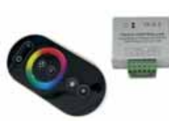
N2414 Dotykový ovladač pro RGB pásy s pokročilou mikro řídicí jednotkou. Ovladač je rádiový, není nutná viditelnost přijímače. Max. zatížení 3x6A/216W.
