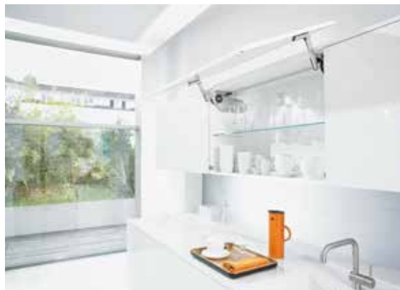
Dvířka s výklopným systémem BLUM AVENTOS HS vybavený tlumeným dovíráním. Vyžaduje více prostoru nad skříňkou, ale umožňuje plný přístup do skříňky i v horní části. Na skříňku není možné ukládat dekorace.
